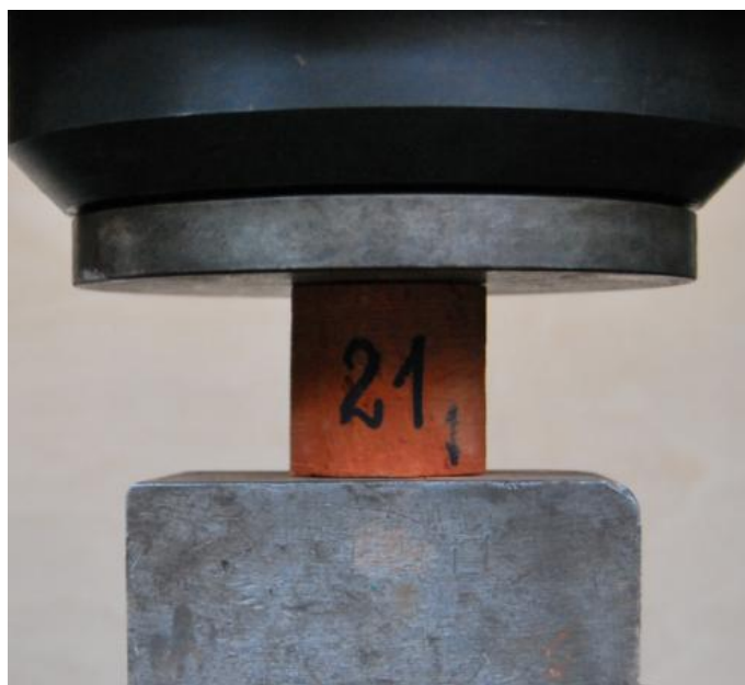
Rys. 4.18 Badanie wytrzymałości na ściskanie próbek walcowych
