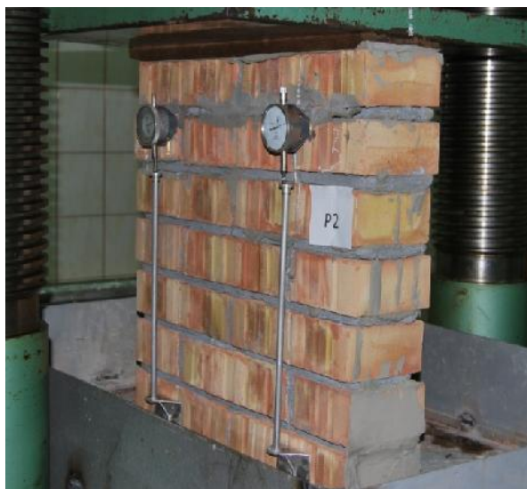
Rys. 6.23 Badanie wytrzymałości na ciśnienie fragmentów nowo wykonanego muru
