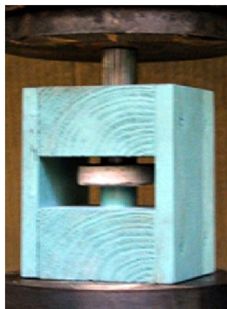
Rys. 5.8 Badanie zaprawy pobranej ze spoin wspornych o grubo ci h_m według normy [116]: 1 – zaprawa, 2 – filc lub gips, 3 – stalowe elementy dociskowe o rednicy 20–25 mm
