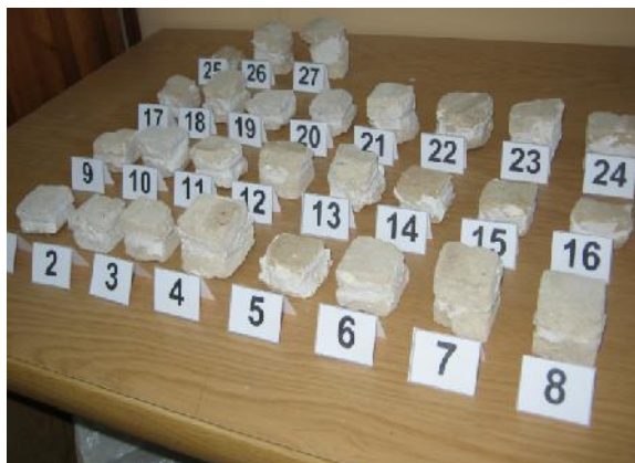
Rys. 5.11 Próbki przygotowane do badań zgodnie ze schematem Rys. 5.7: a) z wyburzanej kamienicy, b) z nowo wykonanego muru
