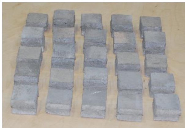
Rys. 5.11 Próbki przygotowane do badań zgodnie ze schematem Rys. 5.7: a) z wyburzanej kamienicy, b) z nowo wykonanego muru
