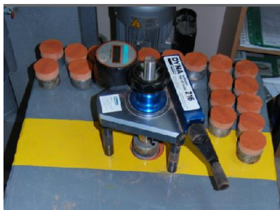
Rys. 6.3 Stanowisko laboratoryjne do określania wytrzymałości cegły na odrywanie metodą pull - off
