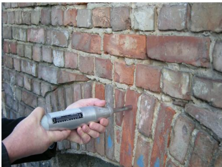
Rys. 4.16 Badanie wytrzymałości na zgniecenie za pomocą młotka Schmidta
