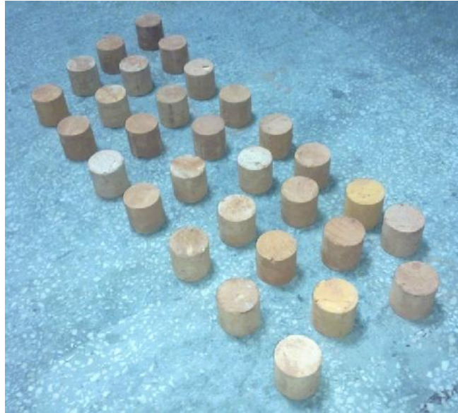
Rys. 6.6 Próbki rdzeniowe przygotowane do badania wytrzymałości na rozciąganie przy rozłupywaniu pobrane z materiału pozyskanego podczas wyburzania kamienicy
