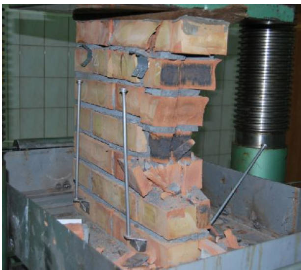
Rys. 6.23 Badanie wytrzymałości na ciśnienie fragmentów nowo wykonanego muru
