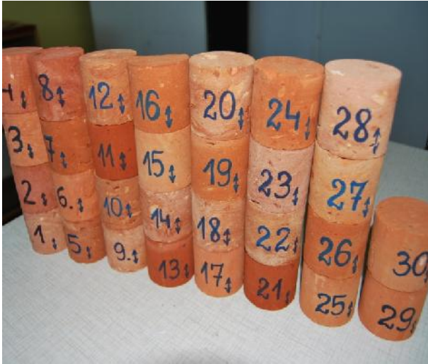
Rys. 4.22 Wyci te próbki rdzeniowe z cegły do bada wytrzymało ci na ciskanie: a) z wyburzanej kamienicy, b) z zakładu ceramicznego
