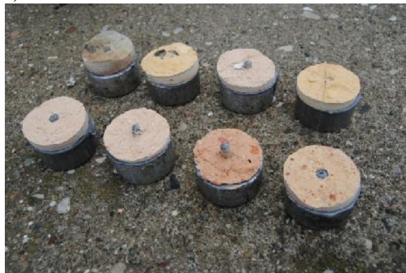
Rys. 6.2 Badanie wytrzymałości cegły na odrywanie in situ metodą pull - off na kominie zlokalizowanym na terenie Zakładu Gazowniczego w Szczecinie
