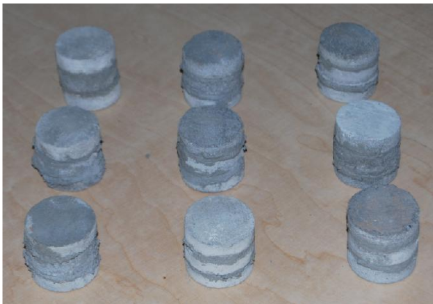
Rys. 6.11 Próbki zaprawy przygotowane do badania wytrzymałości według metody własnej
