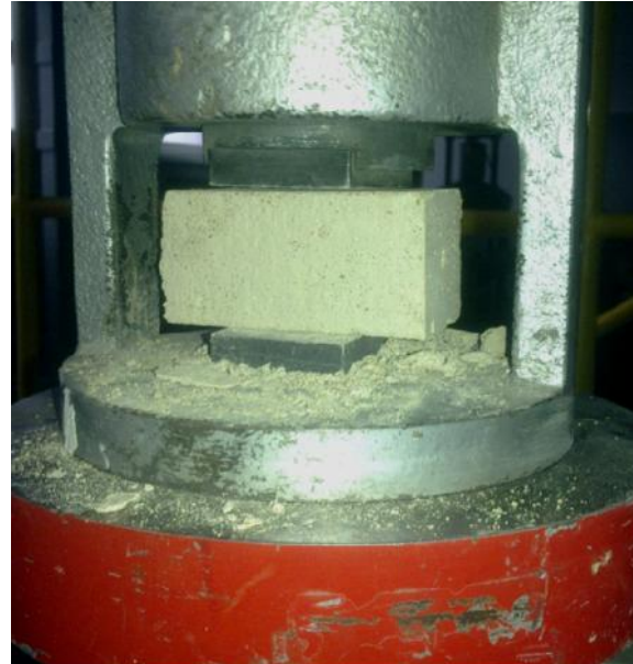
Rys. 5.1 Badanie wytrzymałości na zginanie (a) oraz ciskanie (b) zaprawy zgodnie z norm [127]
