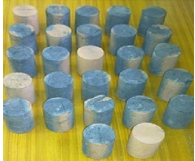
Rys. 4.22 Wyci te próbki rdzeniowe z cegły do bada wytrzymało ci na ciskanie: a) z wyburzanej kamienicy, b) z zakładu ceramicznego
