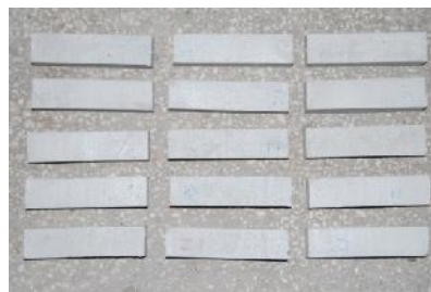
Rys. 5.2 Próbki zaprawy przygotowane do badań wytrzymałościowych zgodnie z norm [127]: a) zaprawa NHL2, b) zaprawa Z01, c) zaprawa K01
