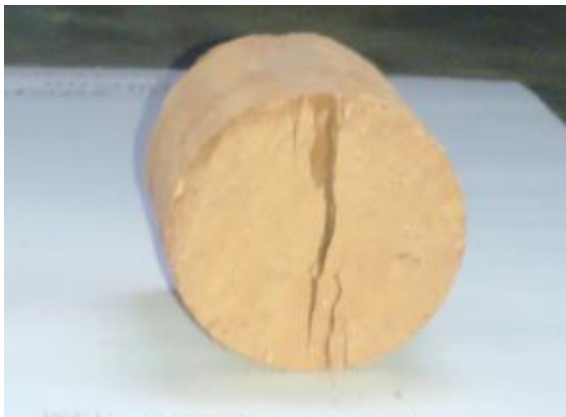
Rys. 6.8 Mechanizm zniszczenia próbek podczas badania wytrzymałości na rozciąganie przy rozłupywaniu
