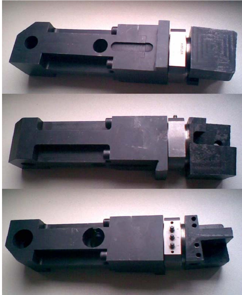
Rys. 4.7. Widok wykonanej oprawki z zamontowanym siłomierzem.
