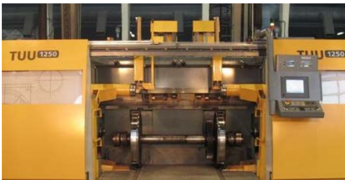
Rys. 2.6. Tokarka kołowa TUU 1250
