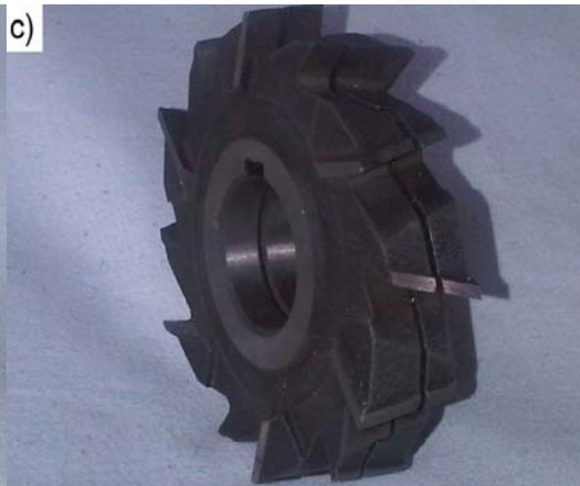
Rys. 2.10. Narzędzia kompensujące układ sił skrawania: a)- frez daszkowy, b)- frez trójścienny naprzemiennie, c)- frez zespołowy naprzemiennie.
