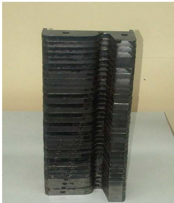
Rys. 6.3. Wykonane i uzbrojone w płytki skrawające kasety narzędzia frezarskiego
