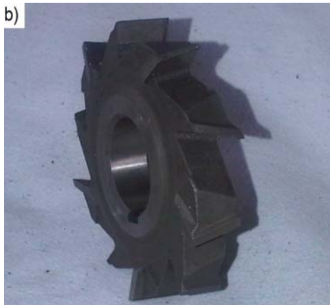
Rys. 2.10. Narzędzia kompensujące układ sił skrawania: a)- frez daszkowy, b)- frez trójścienny naprzemiennie, c)- frez zespołowy naprzemiennie.
