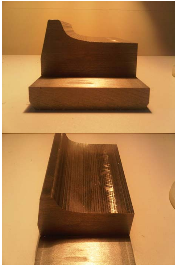
Rys. 6.4. Zdjęcia próbki profilu odwzorowującego zarys otoczki koła jezdnego przygotowana do pomiarów sił skrawania.
