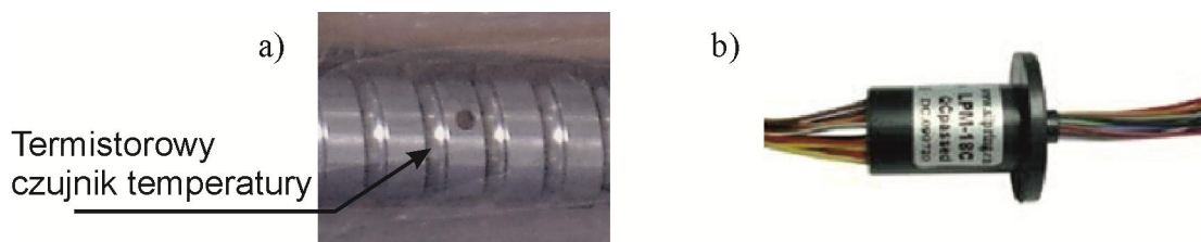
Rys. 5.3 a) czujnik temperatur zamontowany za pomocą kleju termoprzewodzącego w śrubie tocznej b) obrotowe złącze elektryczne zapewniające możliwość ruchu obrotowego układu czujników
