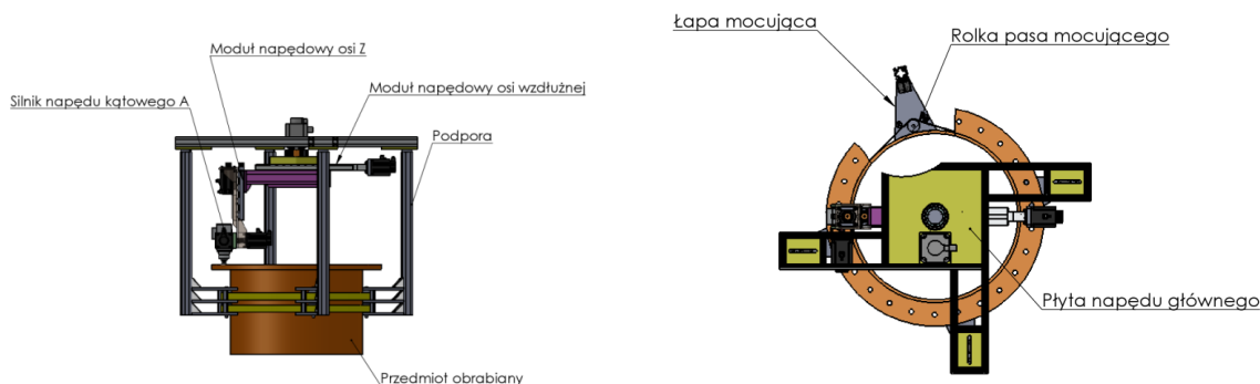
Rys. 6. 18. Widok obrabiarka przenośnej zamocowanej na przedmiocie obrabianym z użyciem bezinwazyjnego systemu montażu
