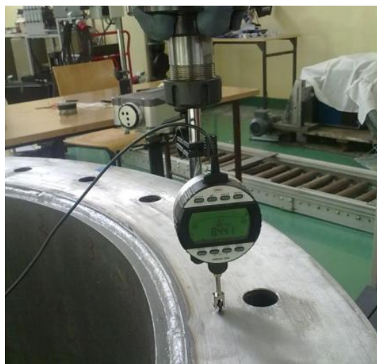
Rys. 8. 5. Pomiar odchyłki a) osiowej, b) odchyłki promieniowej
