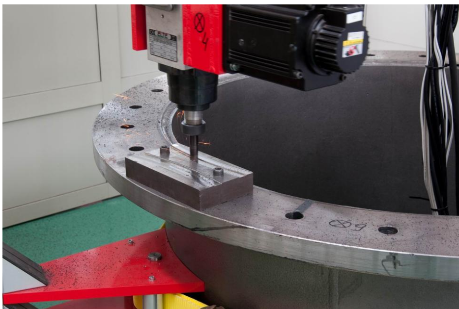
Rys. 8. 30. Próbką zamocowaną na kołnierzu PO w trakcie próby pracy
