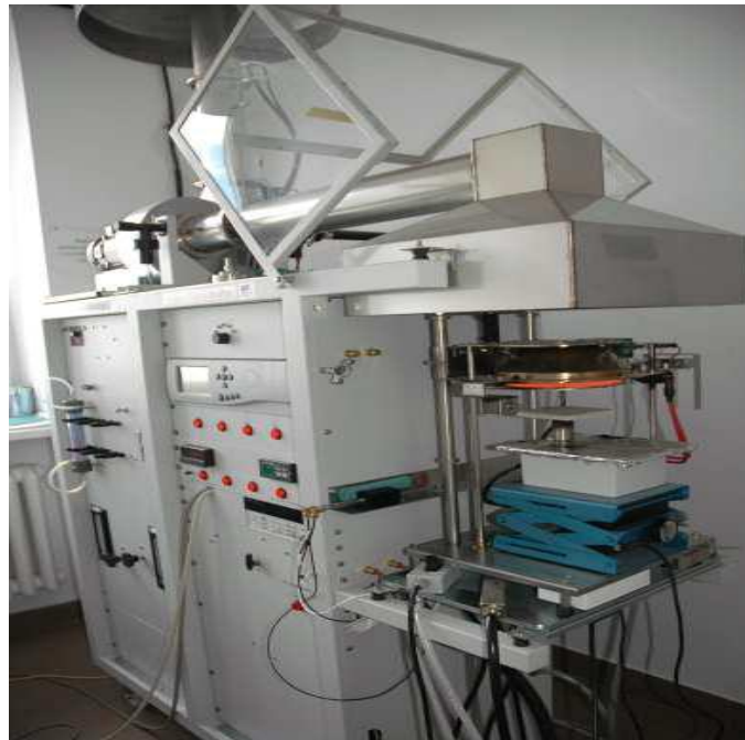
Rys. 20. Kalorymetr stożkowy, znajdujący się w pracowni Zakładu Spalania i Teorii Pożarów w Szkole Głównej Służby Pożarnej
