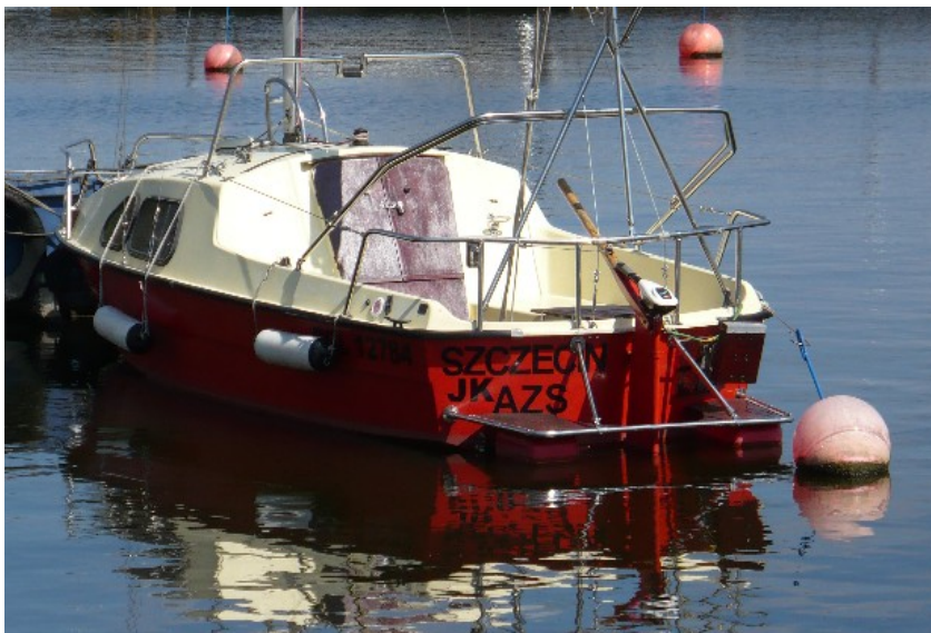
Rys. 7.13. Jacht „na wodzie”; widoczny pomost rufowy i pływaki hydrodynamiczne
