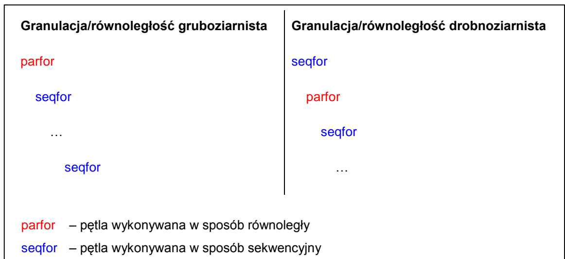
Rysunek 5 Struktury pętli zagnieżdżonych, reprezentujących granulację gruboziarnistą oraz granulację drobnoziarnistą
