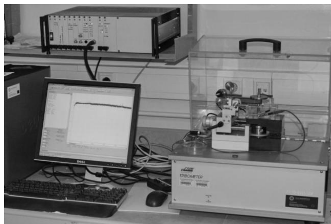
Rys. 5.10. Stanowisko do badań tribokorozyjnych złożone z potencjostatu Atlas 9833 firmy Sollich sterowanego komputerem, komory roboczej (rys.5.9) oraz tribometru TRN S/N 18-324 firmy CSM Instruments
