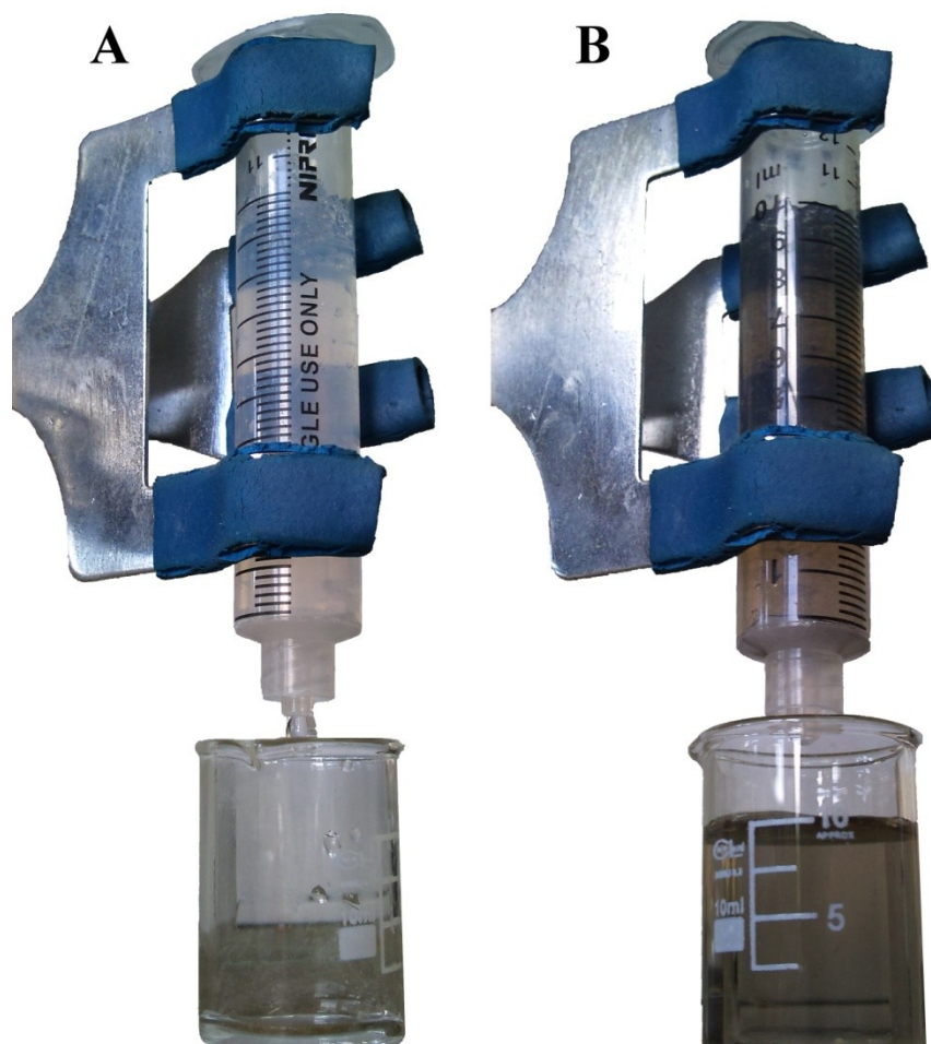
Rysunek 38. Kolumna chromatograficzna wypełniona żelem agarozowym (lewa strona). Kolumna po separacji (prawa strona).
