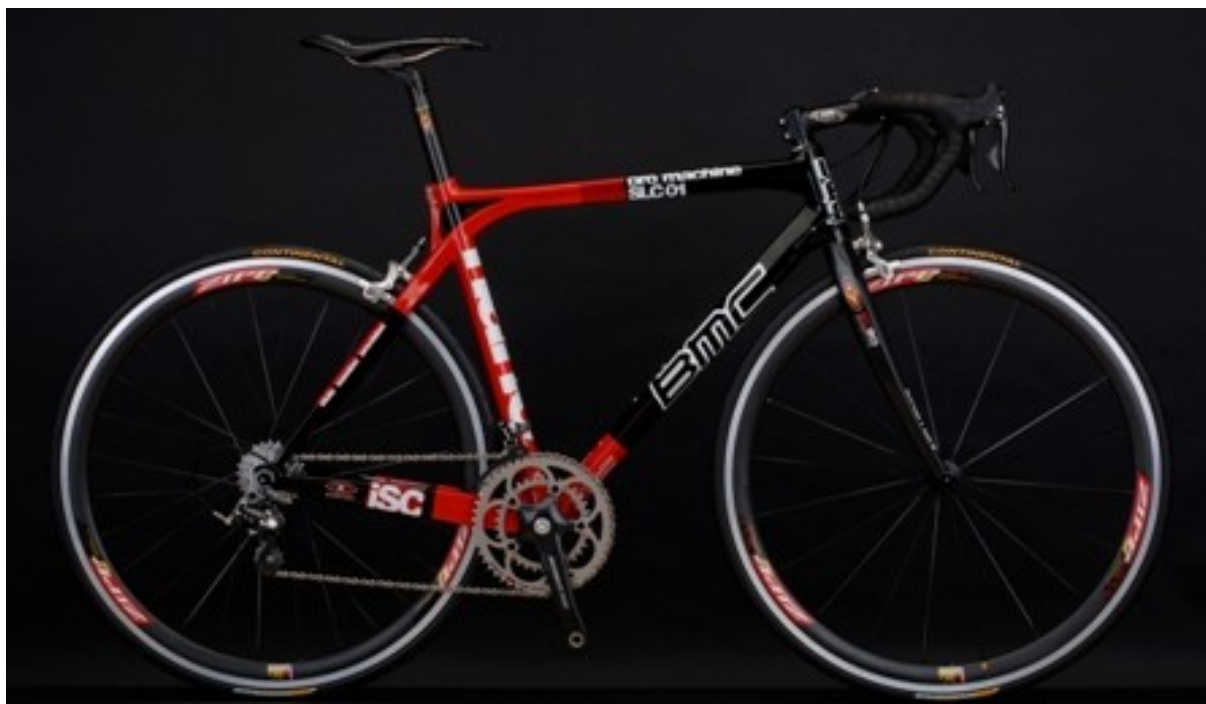
Rysunek 19. Rower firmy BMC o masie 1 kg wyprodukowany z kompozytu na bazie nanorurek węglowych.
