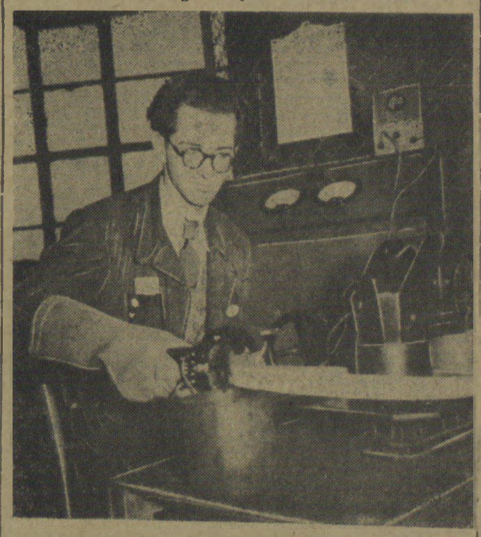
Zaloga ZWAN im. Dymitrowa wykonała 5.XI br. plan roczny. Osiągnięcie to było m. in. możliwe dzięki ofiarnej pracy młodzieży. Np. grupa młodych racjonalizatorów skonstruowała przyrząd do sprawdzania zwarcie międzywojowych w cewkach transformatorowych. Na zdj.: młody racjonalizator, uczeń liceum radiotelegraficznego Zdzisław Gałaszewski przy sprawdzaniu cewek na przyrządzie skonstruowanym przez grupę.
