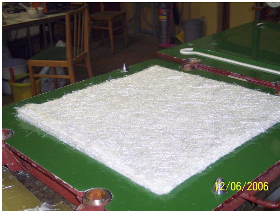
Rys. 16 Wnęka formy z ułożonym wzmocnieniem włóknistym (matą)
