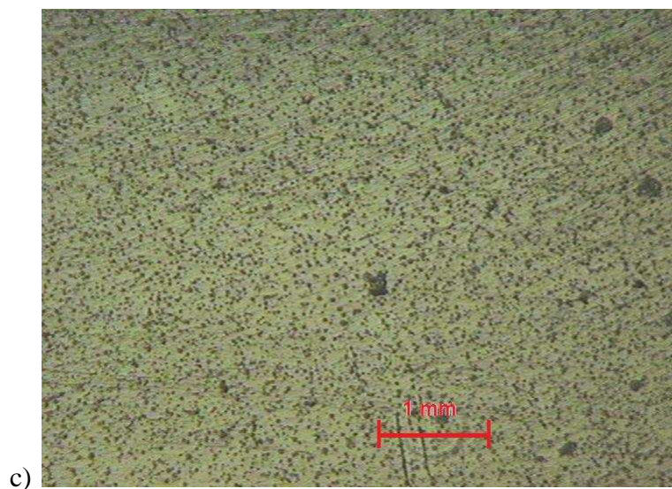
Rys. 48 Mikrografie kompozycji z dodatkiem ETBN w powiększeniu 64x: a) 2ETBN, b) 6ETBN, c) 10ETBN
