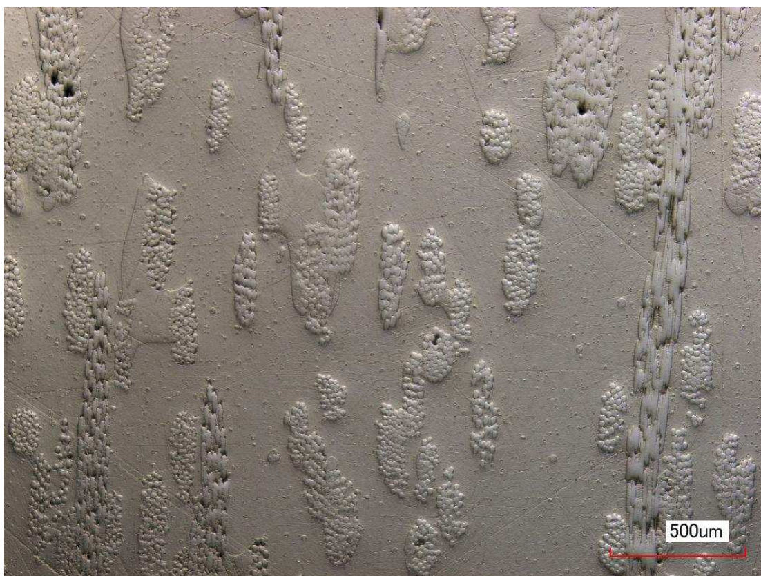
Rys. 93 Mikrografia przekroju kompozytu +2ETBN w powiększeniu 100x (zawartość włókna 23%obj.)
