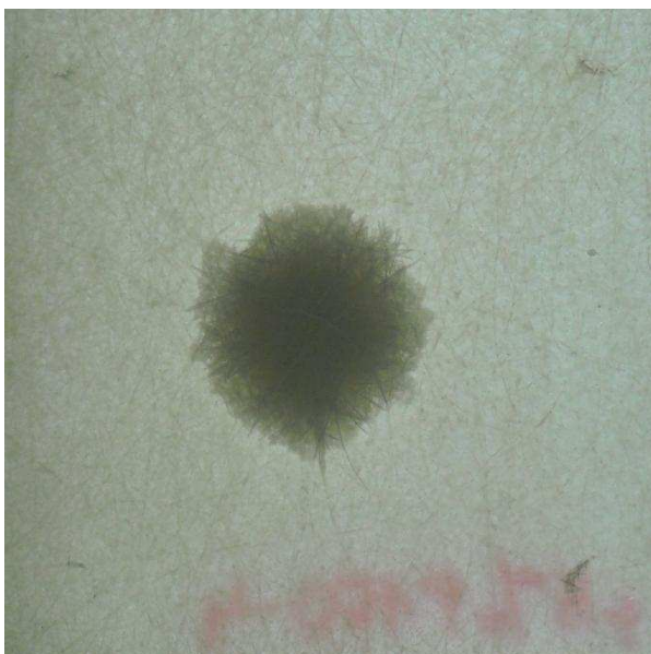
Rys. 108 Przykładowe zdjęcia w świetle przechodzącym tylnej strony kompozytów po udarze: i) 6MP45 po udarze 16 J, j) 6MP45 po udarze 7 J, k) +5P150 po udarze 16 J, l) +5P150 po udarze 7 J
