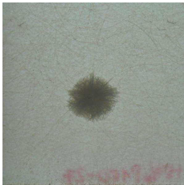
Rys. 108 Przykładowe zdjęcia w świetle przechodzącym tylnej strony kompozytów po udarze: i) 6MP45 po udarze 16 J, j) 6MP45 po udarze 7 J, k) +5P150 po udarze 16 J, l) +5P150 po udarze 7 J
