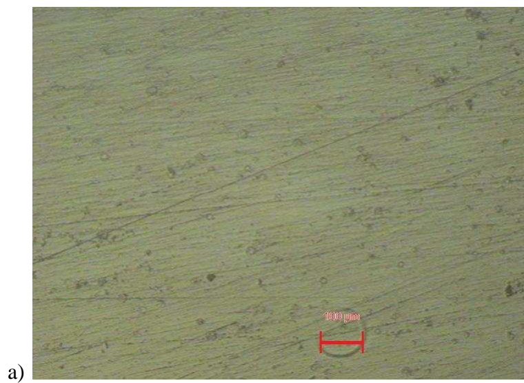
Rys. 49 Mikrografie kompozycji z dodatkiem VTBN w powiększeniu 320x: a) 1VTBN, b) 2VTBN, c) 6VTBN, d) 10VTBN. Czerwony znacznik odpowiada 100 \mu\text{m}
