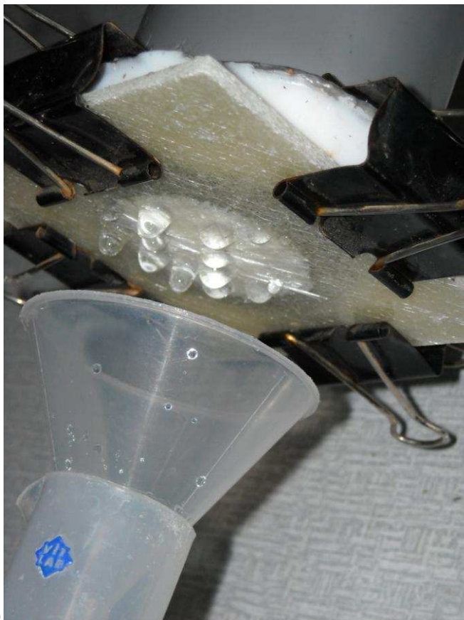
Rys. 24 a) Schemat stanowiska do badania przecieku wody. b) Próba przecieku wody przez uszkodzony kompozyt wzmocniony matą. Woda przesącza się w postaci widocznych kropli
