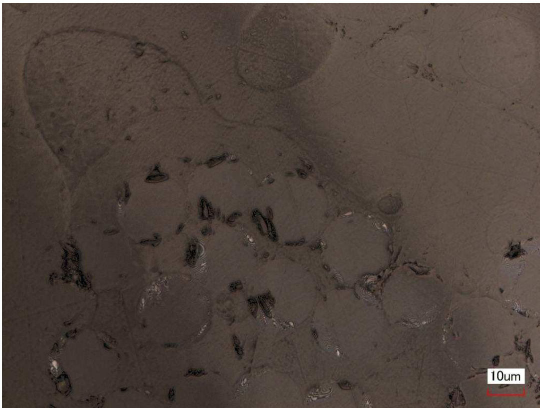
Rys. 107 Przekrój kompozytu +6VTBN: a) w powiększeniu 1000x, widoczne wydzielania, b) w powiększeniu 1000x, widoczne wydzielania, c) w powiększeniu 1000x, widoczne wydzielania, d) w powiększeniu 2000x, widoczne wydzielania, e) w powiększeniu 2000x, widoczne wydzielania z których jedno otacza pasmo włókien
