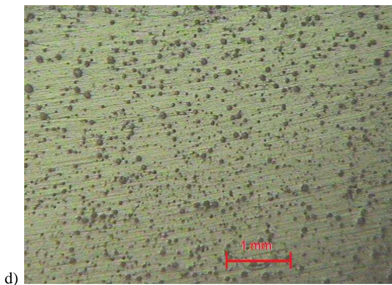
Rys. 47 Mikrografie kompozycji z dodatkiem VTBN w powiększeniu 64x: a) 1VTBN, b) 2VTBN, c) 6VTBN, d) 10VTBN
