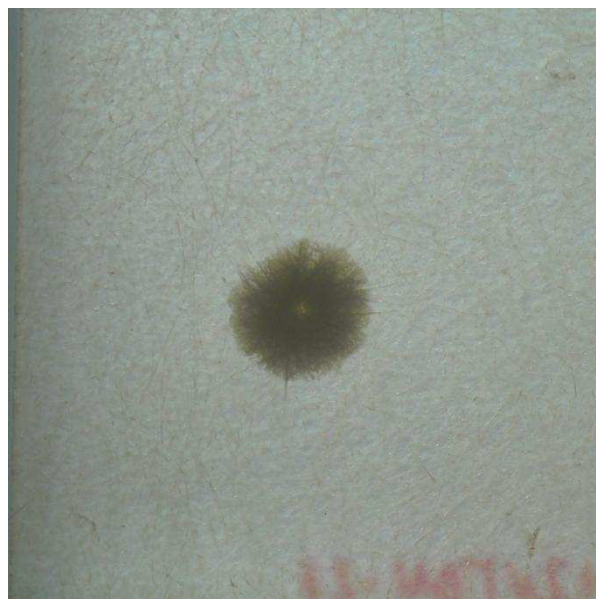
Rys. 108 Przykładowe zdjęcia w świetle przechodzącym tylnej strony kompozytów po udarze: q) +6ETBN po udarze 16 J, r) +6ETBN po udarze 7 J, s) +2VTBN po udarze 16 J, t) +2VTBN po udarze 7 J
