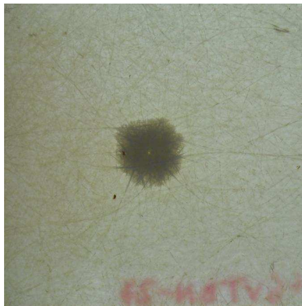
Rys. 108 Przykładowe zdjęcia w świetle przechodzącym tylnej strony kompozytów po udarze: u) +6VTBN po udarze 16 J, v) +6VTBN po udarze 7 J
