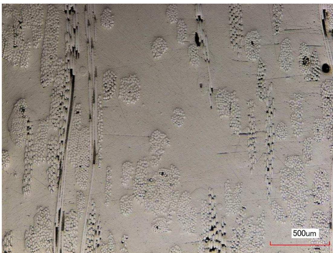
Rys. 91 Mikrografia przekroju kompozytu +5P150 w powiększeniu 100x (zawartość włókna 23%obj.)
