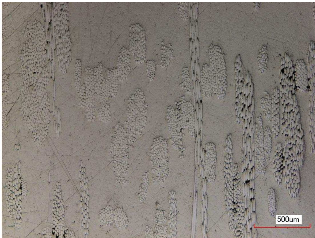
Rys. 94 Mikrografia przekroju kompozytu +6ETBN w powiększeniu 100x (zawartość włókna 23%obj.)
