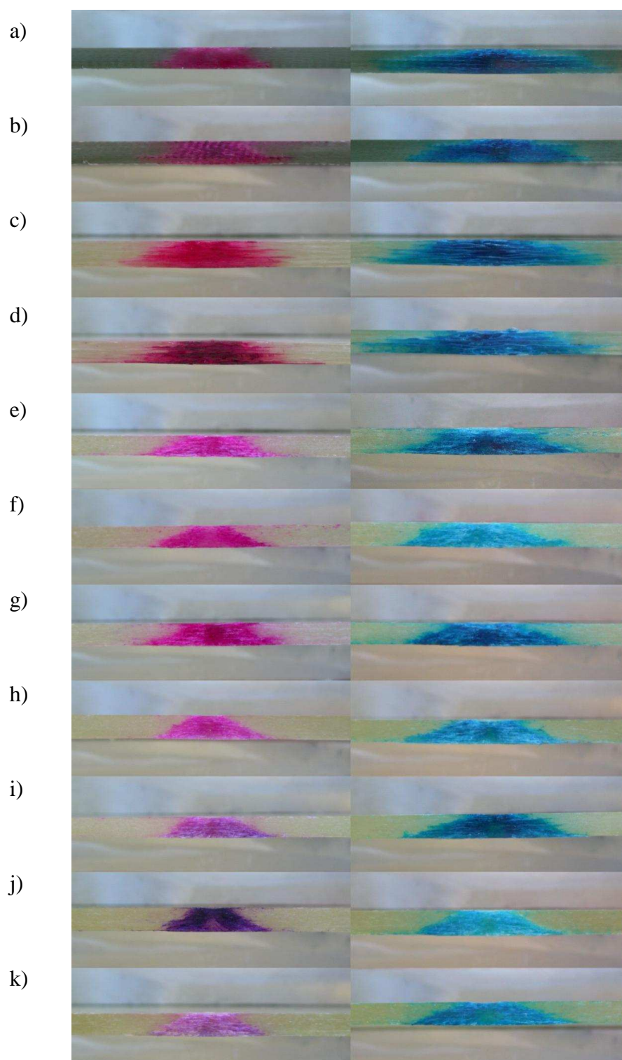
Rys. 134 Fotografie przekrojów poprzecznych przez obszary uszkodzone poszczególnych kompozytów: a) 26TR17, b) 22TJ20, c) 10PR43, d) 6PR43, e) 6MP45, f) +5P150, g) +15P150, h) +2ETBN, i) +6ETBN, j) +2VTBN, k) +6VTBN. Próbki po uderze o energii 7 J (po lewej) i 16 J (po prawej). Uderzenie od góry rysunku.
