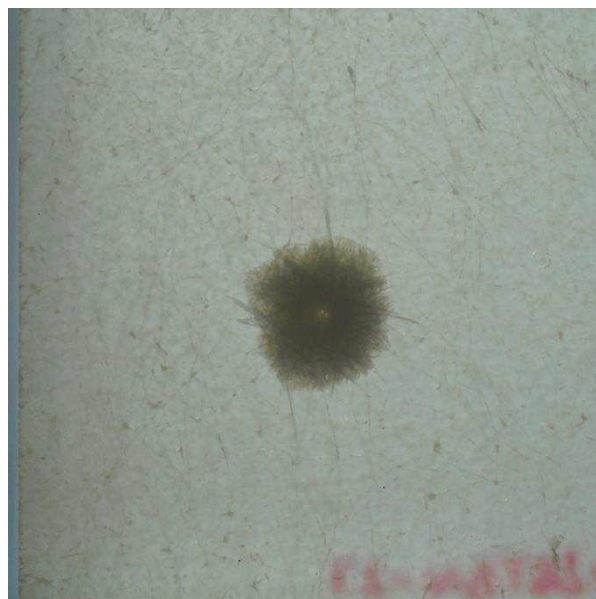
Rys. 108 Przykładowe zdjęcia w świetle przechodzącym tylnej strony kompozytów po udarze: m) +15P150 po udarze 16 J, n) +15P150 po udarze 7 J, o) +2ETBN po udarze 16 J, p) +2ETBN po udarze 7 J
