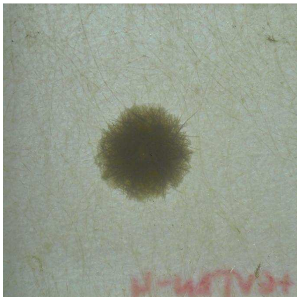
Rys. 108 Przykładowe zdjęcia w świetle przechodzącym tylnej strony kompozytów po udarze: u) +6VTBN po udarze 16 J, v) +6VTBN po udarze 7 J
