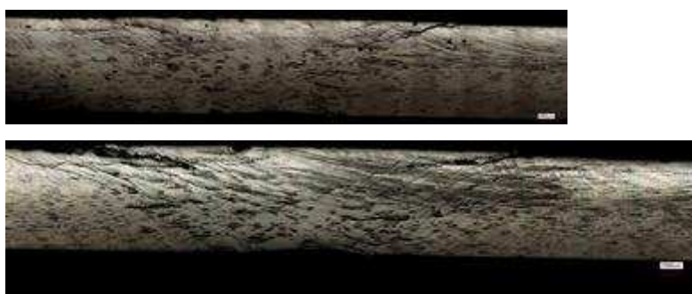
Rys. 144 Mikrografie zglądów kompozytu +2VTBN po udarze o energii 7 J (u góry) i 16 J (u dołu)
