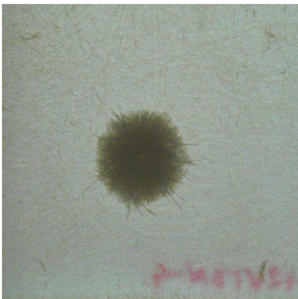
Rys. 108 Przykładowe zdjęcia w świetle przechodzącym tylnej strony kompozytów po udarze: q) +6ETBN po udarze 16 J, r) +6ETBN po udarze 7 J, s) +2VTBN po udarze 16 J, t) +2VTBN po udarze 7 J
