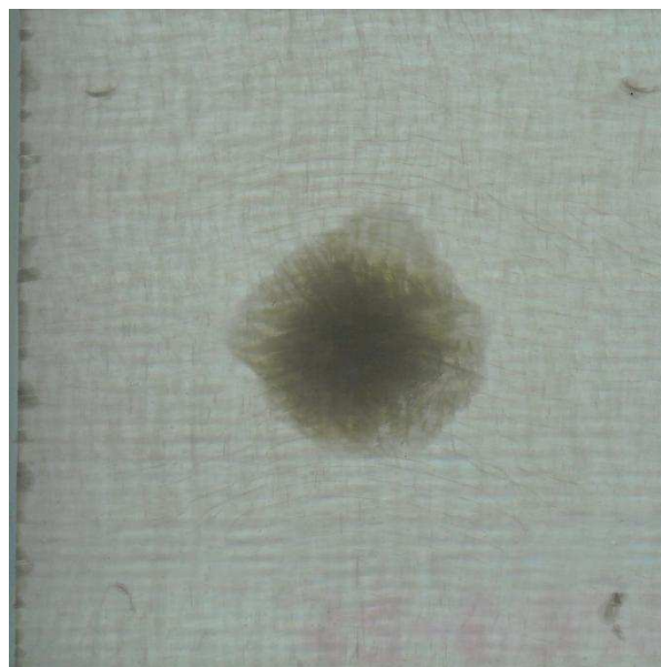
Rys. 108 Przykładowe zdjęcia w świetle przechodzącym tylnej strony kompozytów po udarze: e) 10PR43 po udarze 16 J, f) 10PR43 po udarze 7 J, g) 6PR43 po udarze 16 J, h) 6PR43 po udarze 7J
