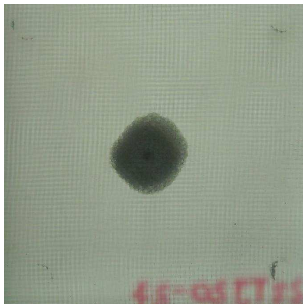
Rys. 108 Przykładowe zdjęcia w świetle przechodzącym tylnej strony kompozytów po udarze: a) 26TR17 po udarze 16 J, b) 26TR17 po udarze 7 J, c) 22TJ20 po udarze 16 J, d) 22TJ20 po udarze 7 J
