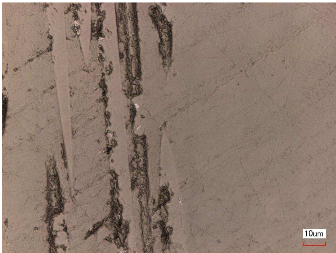
Rys. 97 Przekrój kompozytu 26TR17 w powiększeniu 2000x
