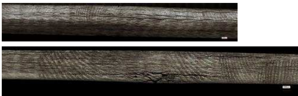
Rys. 136 Mikrografie zglądów kompozytu 22TJ20 po udarze o energii 7 J (u góry) i 16 J (u dołu)
