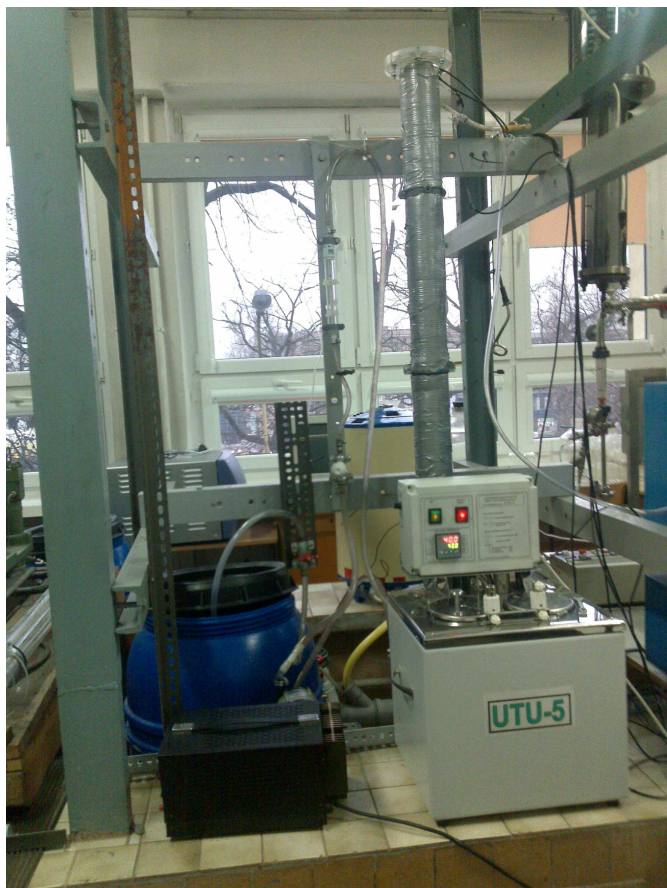
Rys. 4.35. Ogólny widok instalacji badawczej procesu bioadsorpcji jonów Fe(III) z roztworów wodnych na badanych nieruchomych złożach
