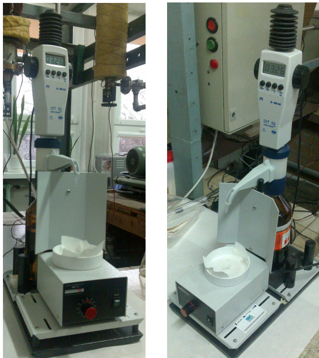
Rys. 4.11. Widok ogólny aparatury do ręcznego miareczkowania roztworu wodnego Fe(III)
