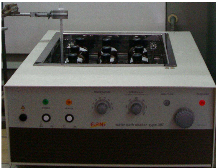
Rys. 4.10. Stanowisko badawcze do wykonywania pomiarów izoterm równowagi
