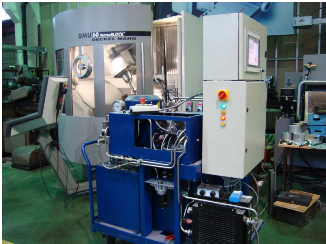
Rysunek 3-44. Zasilacz hydrauliczny w trakcie automatycznej pracy podczas nagniatania na obrabiarce pięcioosiowej
