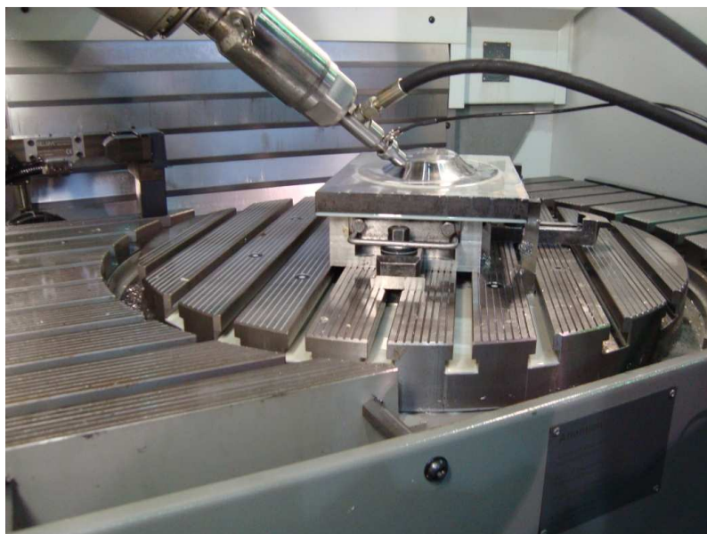
Rysunek 4-30. Widok nagniatka miechowego z końcówką d_k=10 [mm] podczas obróbki pięcioosiowej
