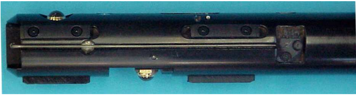
Rysunek 1-23. Nagniatak hydrostatyczny do nagniatania otworów przelotowych
