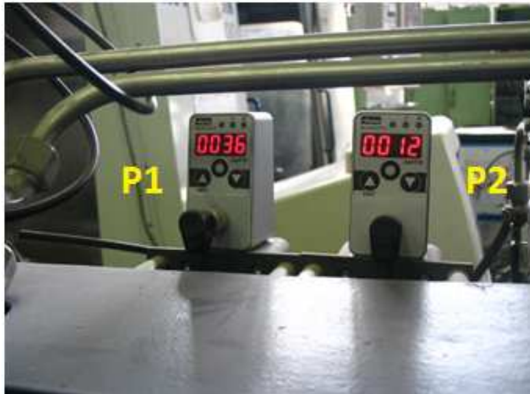
Rysunek 3-37. Manometry cyfrowe podczas pracy urządzenia a) ciśnienie panujące w łożysku, b) ciśnienie zasilania komory tłokowej narzędzia
