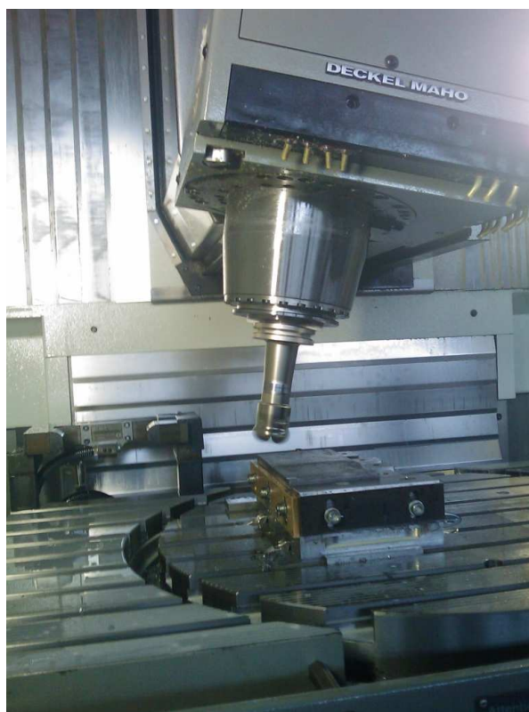
Rysunek 4-2. Frezowanie kształtujące próbek na centrum obróbkowym DMU-60 MONOBLOCK
