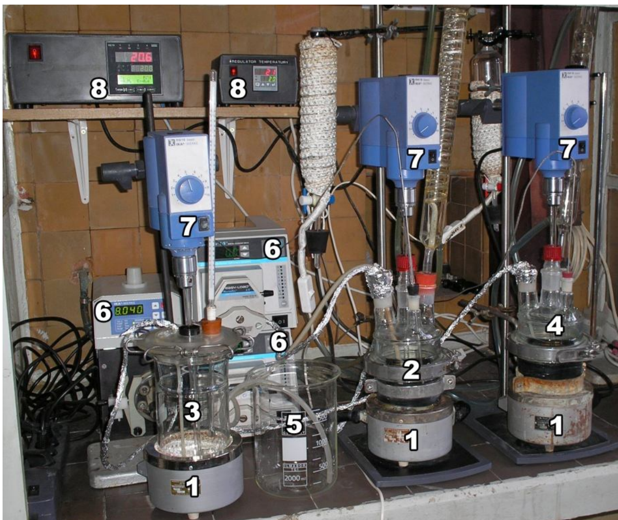
Rys. 5. Schemat aparatury stosowanej w procesie hydrolizy siarczanu(VI) tytanu metodą ciągłą: 1 – czasza grzejna połączona z regulatorem temperatury, 2 – reaktor–hydrolizer, 3 – zbiornik załężonego ługu tytanowego, 4 – zbiornik wody, 5 – odbieralnik zawiesiny \text{TiO}_2 \cdot n\text{H}_2\text{O} w pohydrolitycznym kwasie siarkowym, 6 – pompa perystaltyczna, 7 – mieszadło mechaniczne z płynną regulacją obrotów, 8 – cyfrowy regulator temperatury
