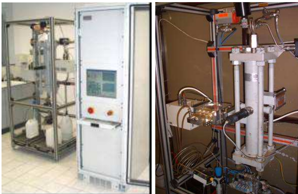
Rysunek 3. Reaktor z emisją mikrofal do syntez solwotermalnych.
