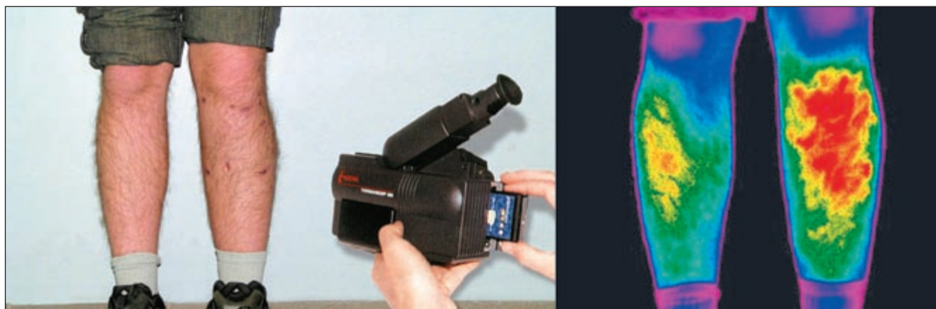
Ryc. 1. Istota termowizji – wizualizacja promieniowania ciepłego
