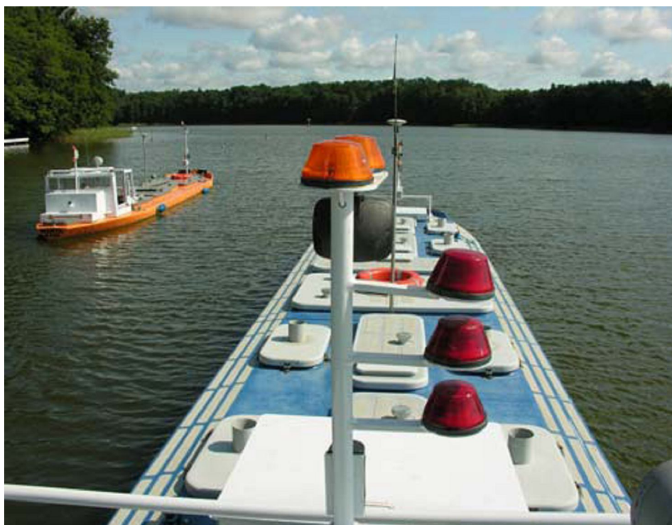
Rys. 3.4 Model redukcyjny biorący udział w badaniach rzeczywistych wyznaczania w jaki sposób odległość boczna od obiektów obcych zależy od odległości rozpoczęcia manewru i kąta wychylenia płetwy sterowej. Źródło: (Lizakowski, 2008).
