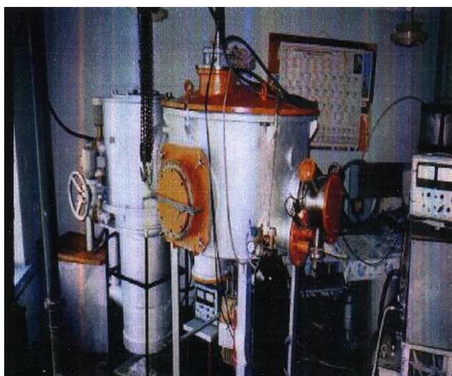
Rysunek 5.6. Widok urządzenia do implantacji jonowej Źródło: [53]
