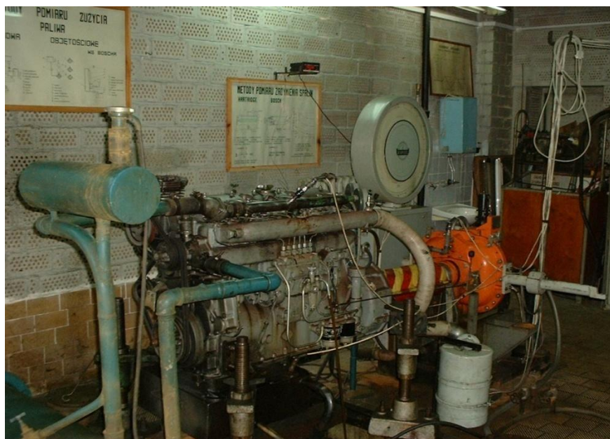
Rysunek 7.5. Widok stanowiska eksperymentalnego wyposażonego w silnik 359 oraz hamulec hydrauliczny
