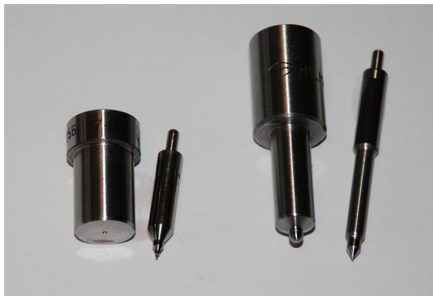
Rysunek 6.2. Końcówki z iglicami wtryskiwacza czopikowego i wielootworowego
