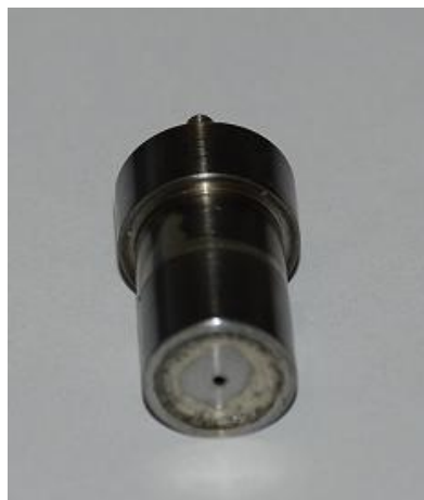
Rysunek 6.4. Końcówka zmodyfikowanego wtryskiwacza czopikowego
