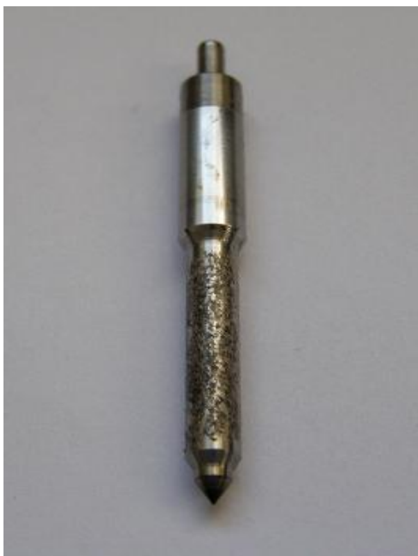
Rysunek 6.5. Iglica wtryskiwacza z katalizatorem nałożonym metodą elektroiskrową
